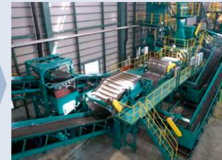
磁力選別ライン 磁力で鉄を選別・回収します。
