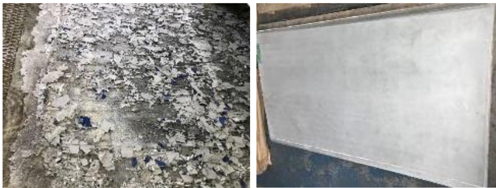
図表 43 熱分解後のパネル外観
